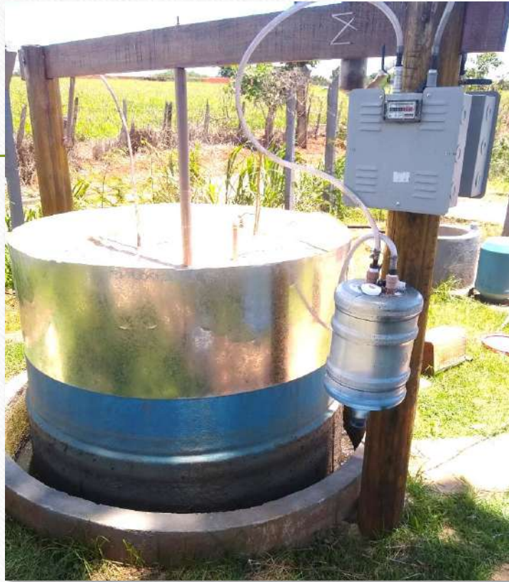
Figura: Biodigestor de cúpula flutuante (Tipo Sertanejo ou Indiano) para tratamento de de esterco bovino e geração de biogás. BiogasLab IFG-UFG, Goiânia, GO, 2020.
