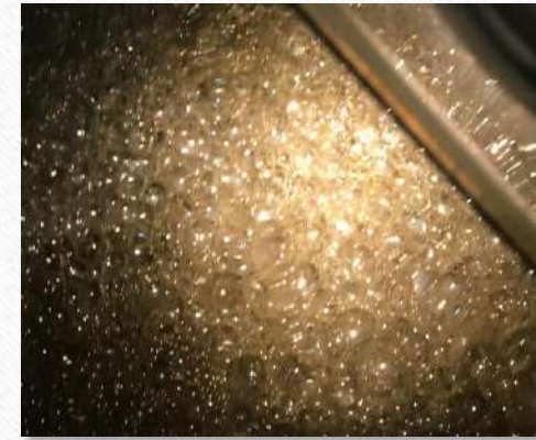
Figura: Bolhas de biogás dentro do digestor.
