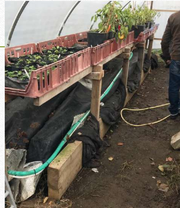
Figura: Biodigestor tubular em uma estufa para tratamento de esterco bovino e geração de biogás para cozinha, Surrey Docks Farm, Londres, Reino Unido. 2018.
